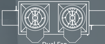
Dual Fan Plenum System
